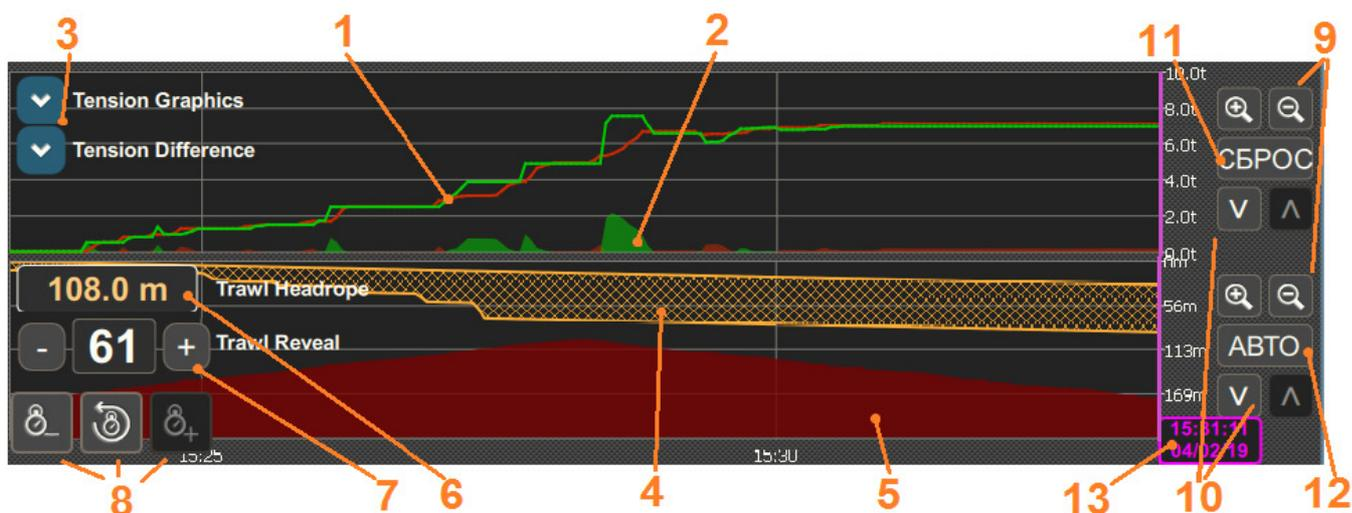
Рис. 6.4 Графики натяжения и глубины хода трала
